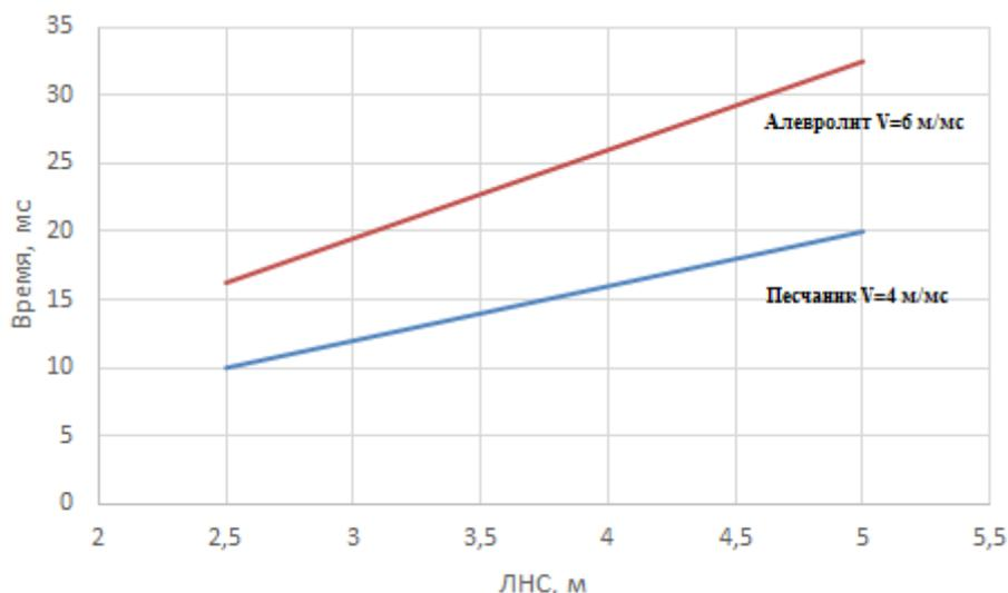
Рисунок 3.3 – Зависимость интервала замедления с учетом величины ЛНС для различных горных пород и скорости распространения ударной волны создающей на своем пути поле начальных напряжений
