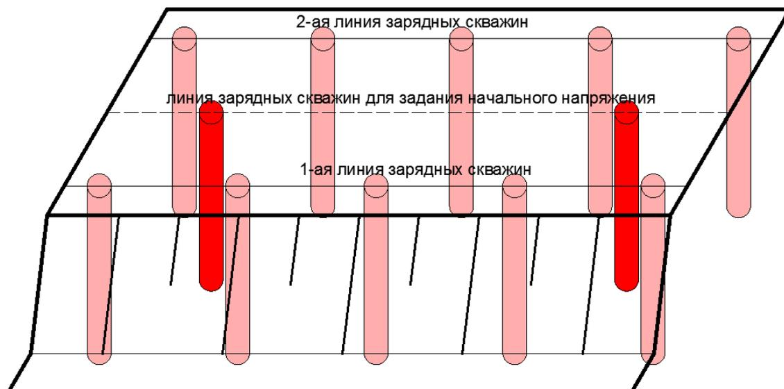
Рисунок 2.1 - Предлагаемая схема расположения скважин
