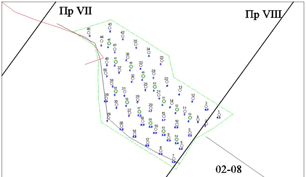
Второй базовый взрыв. Сетка бурения 4,5\*4,5м
