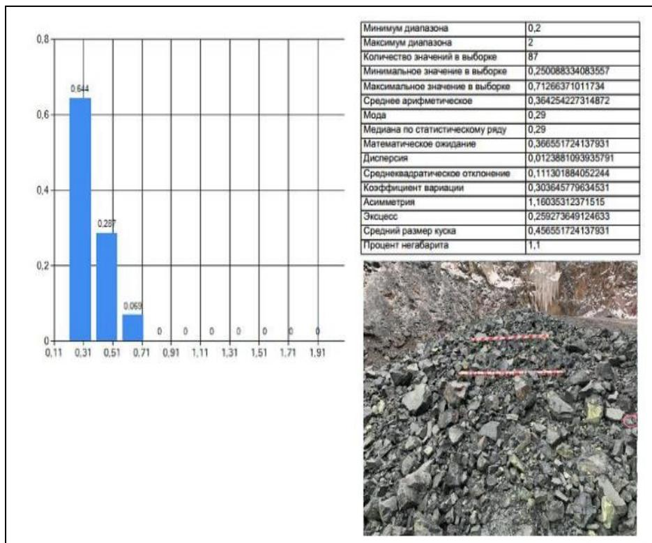
Рисунок 4.3 – Анализ №3 гранулометрического состава взорванной горной массы с применением программного комплекса K-Mine Granules (1 базовый взрыв)
