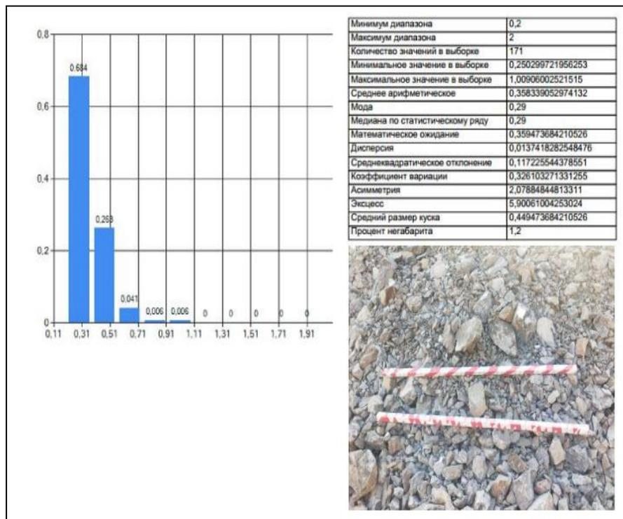
Рисунок 4.8 – Анализ №2 гранулометрического состава взорванной горной массы с применением программного комплекса K-Mine Granules (2 базовый взрыв)
