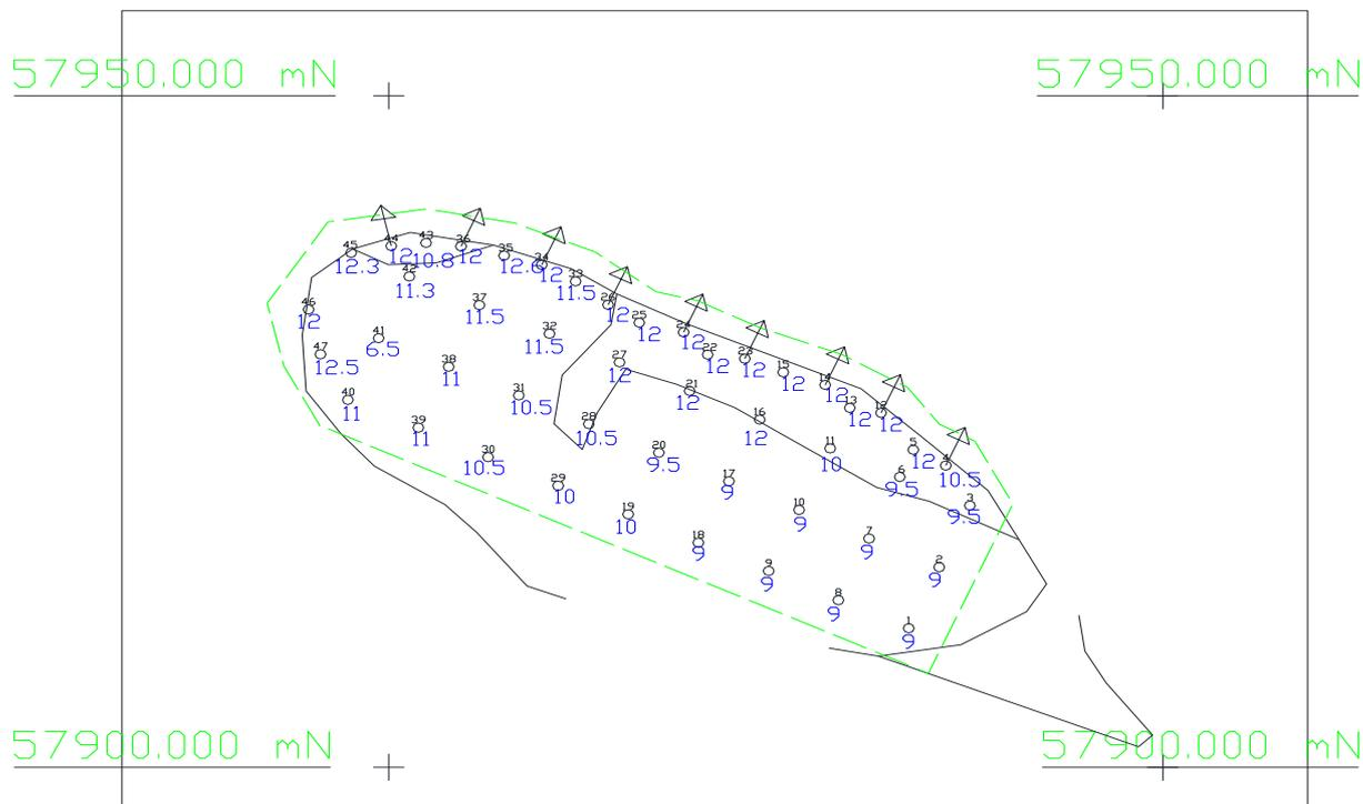
Расчеты БВР. Первый базовый взрыв. Сетка 4\*4м
