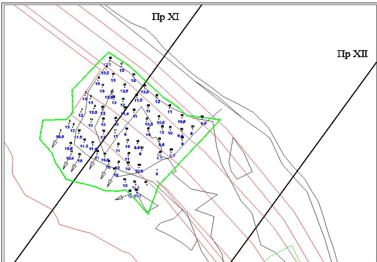
Третий базовый взрыв. Сетка бурения 5,0\*5,0м
