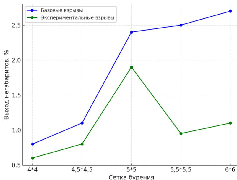
Рисунок 4.21 - Зависимость изменения выхода негабаритов при базовой и предлагаемой технологиях от сетки расположения скважин
