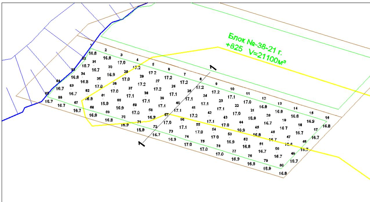
Второй экспериментальный взрыв. Сетка бурения 4,5\*4,5м с дополнительными скважинами
