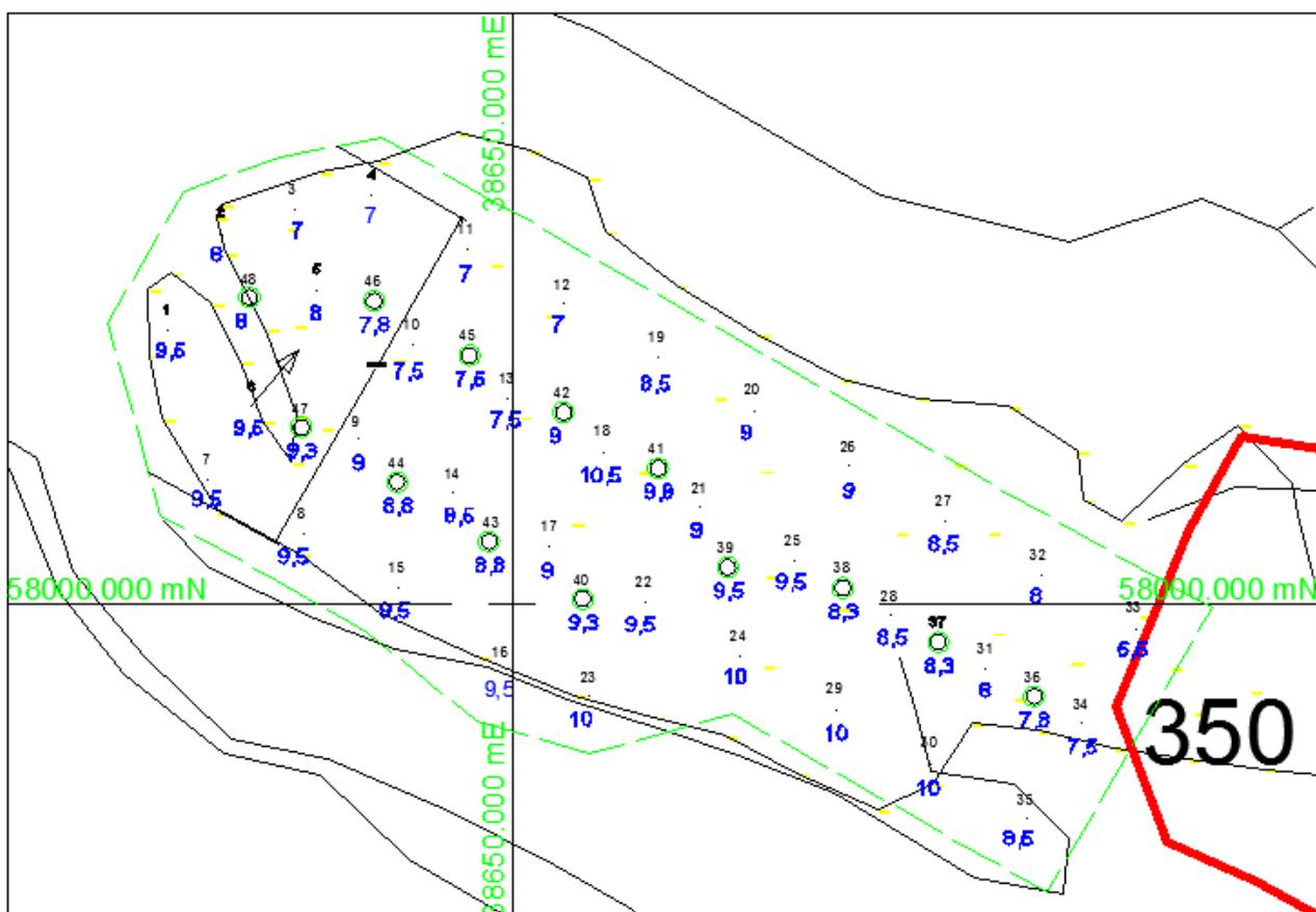
Второй экспериментальный взрыв. Сетка бурения 5,0\*5,0м с дополнительными скважинами
