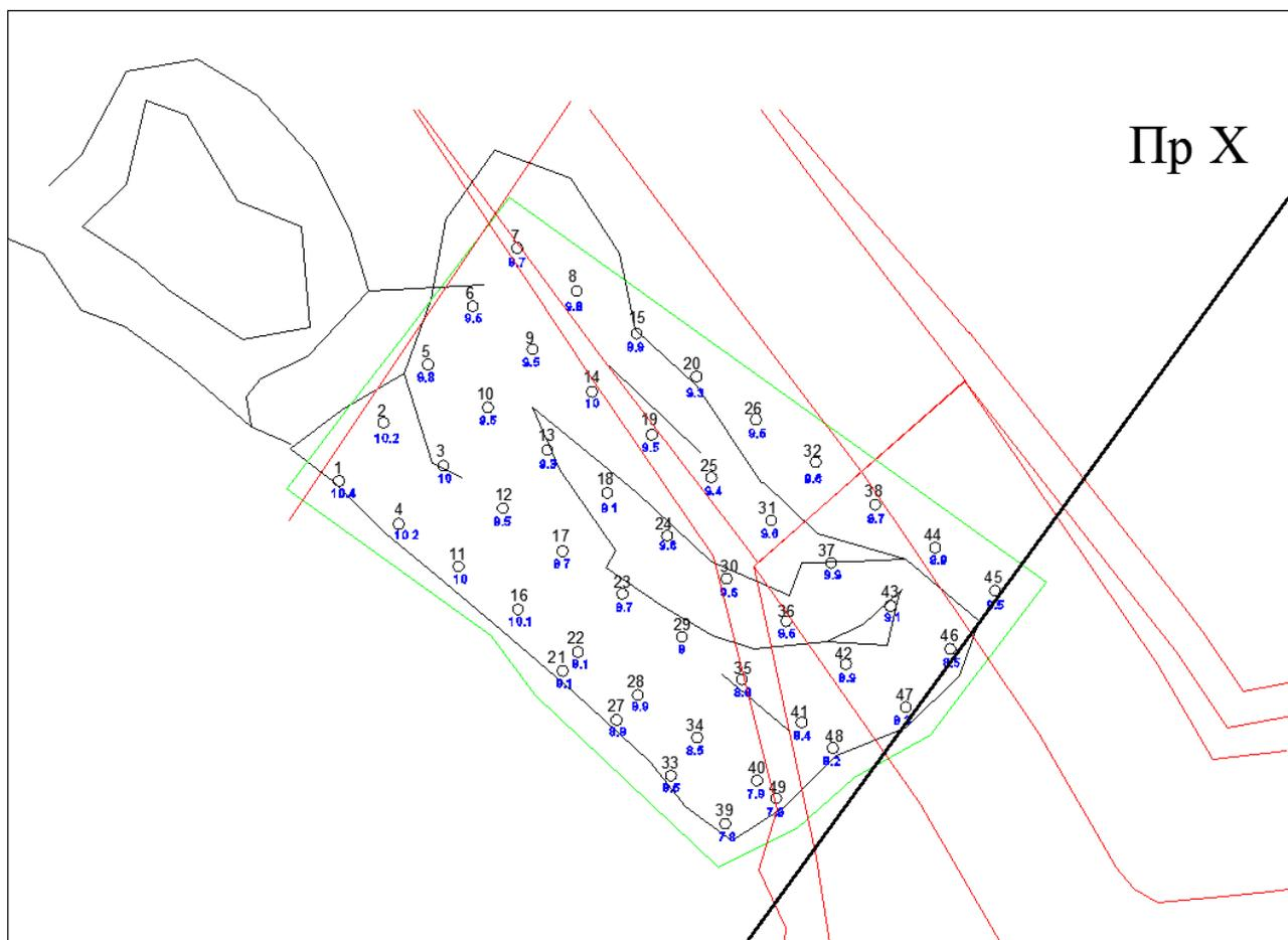
Первый экспериментальный взрыв. Сетка бурения 4,0\*4,0м с дополнительными скважинами
