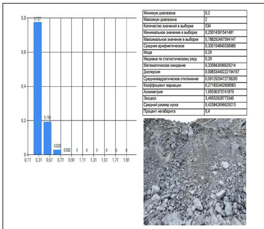
Рисунок 4.6 – Анализ №3 гранулометрического состава взорванной горной массы с применением программного комплекса K-Mine Granules (1 экспериментальный взрыв)
