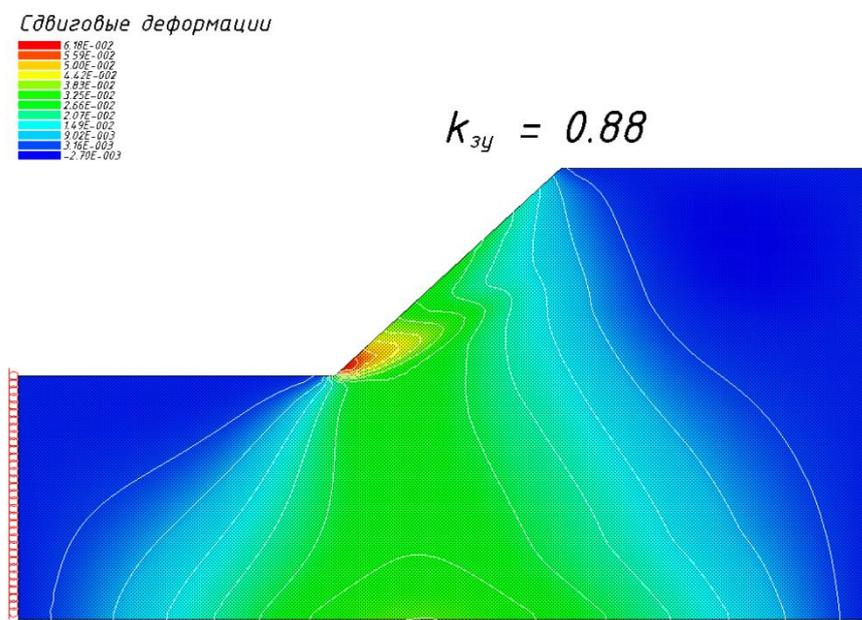
Рисунок 4.29 - Пример расчета коэффициента запаса методами МКЭ в программном обеспечении K-MINE
