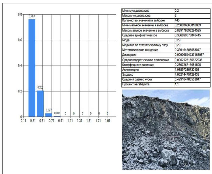
Рисунок 4.12 – Анализ №3 гранулометрического состава взорванной горной массы с применением программного комплекса K-Mine Granules (2 экспериментальный взрыв)
