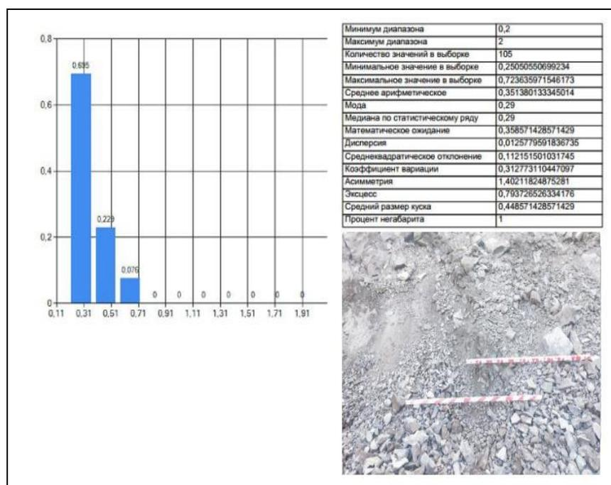
Рисунок 4.10 – Анализ №1 гранулометрического состава взорванной горной массы с применением программного комплекса K-Mine Granules (2 экспериментальный взрыв)
